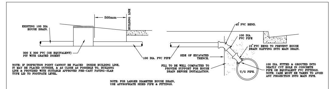
CONNECTION OF HOUSE DRAINS TO UNDERGROUND STREET DRAIN.
